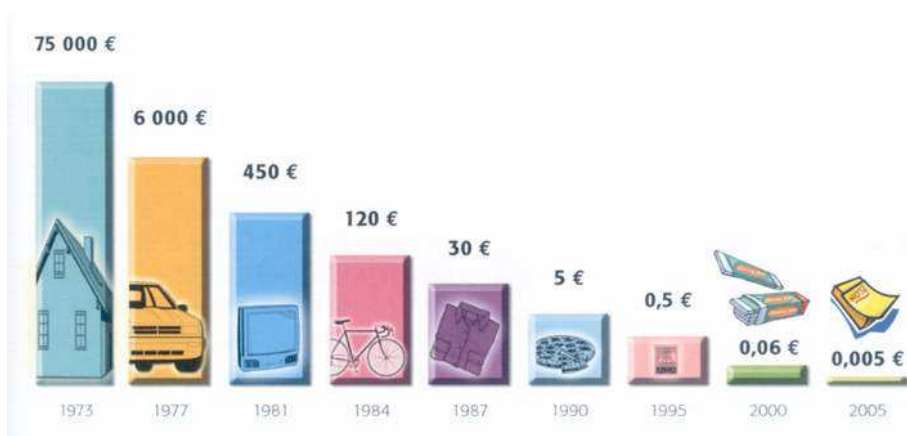
Figure 6 : Evolution de la valeur équivalente d'un circuit d'un million de transistors
